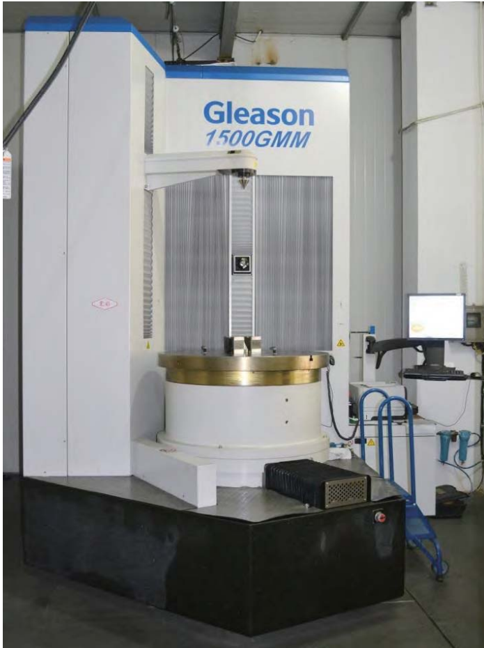
格里森1500GMM齿轮测量中心 Gleason 1500GMM Inspection Center 直径Diameter : 1500 承重Max Weight : 4.5t
