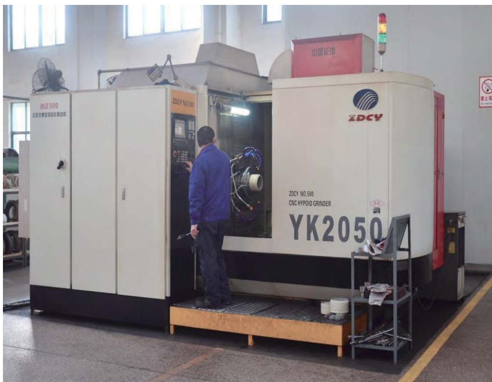
湖南中大创远全数控500弧齿成型磨 ZDCY CNC Profile Grinding Machine for spiral bevel gears 直径 Diameter: 500 模数 Module: 12 精度 Precision grade: GB5级
