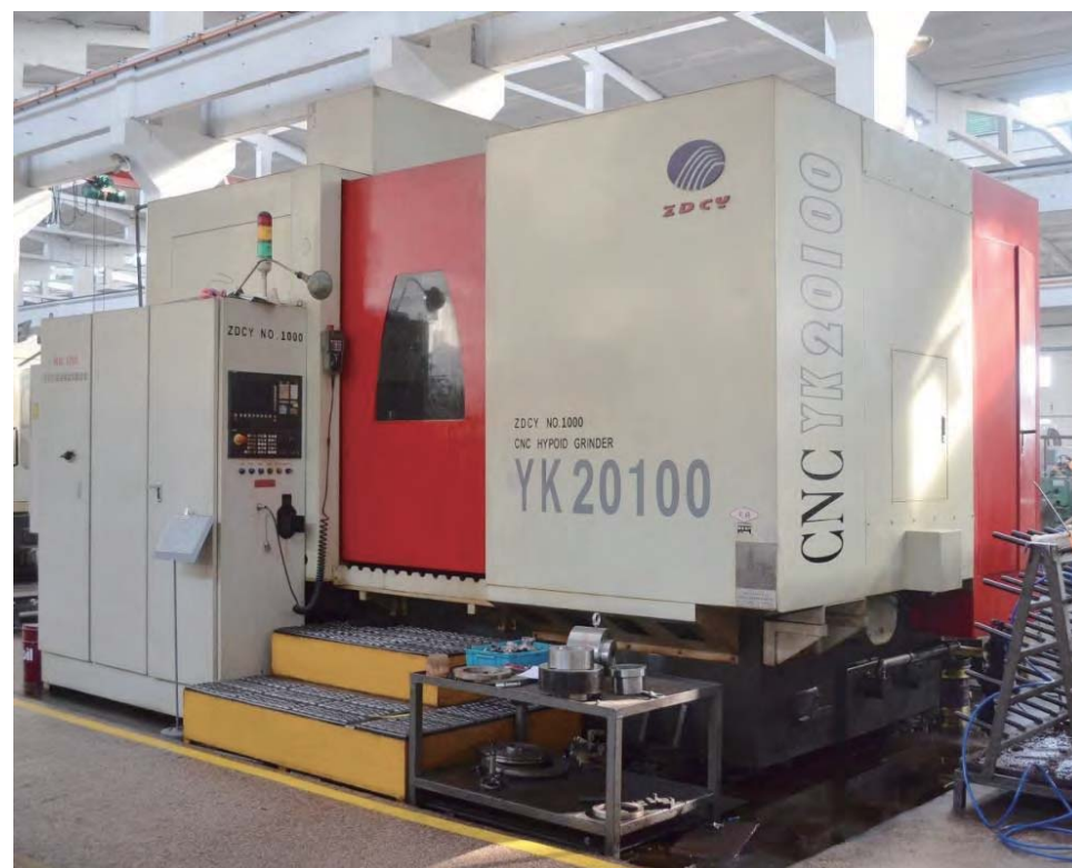
湖南中大创远全数控1000弧齿成型磨 ZDCY CNC Profile Grinding Machine for spiral bevel gears 直径 Diameter: 1000 模数 Module: 20 精度 Precision grade: GB5级
