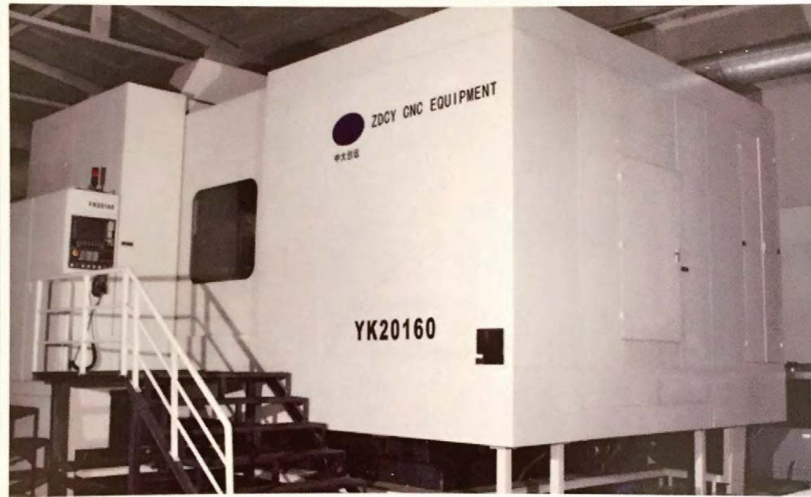
2010年展览全球最大弧齿成型磨 湖南中大创远全数控1600弧齿成型磨 ZDCY CNC Profile Grinding Machine for spiral bevel gears 直径 Diameter: 1600 模数 Module: 30 精度 Precision grade: GB5级
